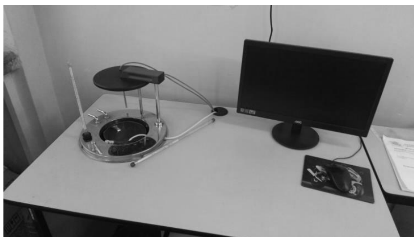
Rys. 5. Stanowisko do badania wartości opałowej i ciepła spalania za pomocą bomby kalorymetrycznej KL-12Mn
